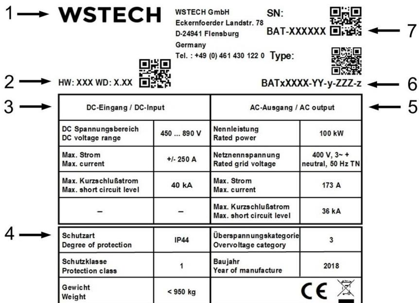
Abbildung 1: Beispiel eines Typenschildes
